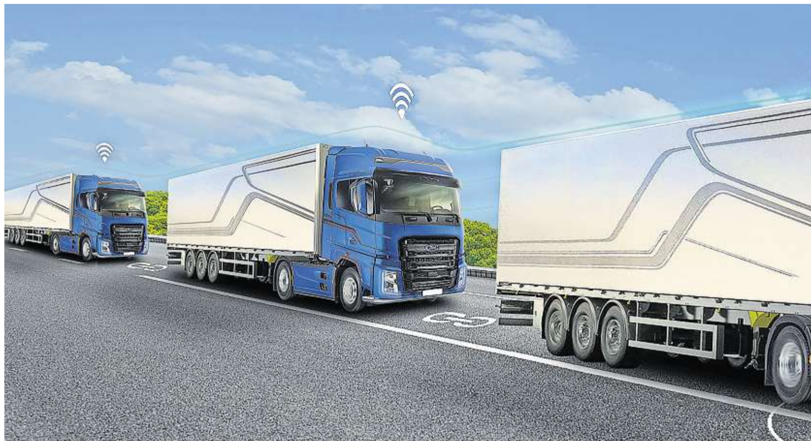
So soll Platooning funktionieren: Elektronisch angekoppelte Fahrzeuge folgen in dichtem Abstand dem Führungs-Lkw.
